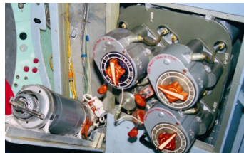
図 1-3-1-宇宙ステーション用酸素発生カートリッジ、(Solid-Fuel Oxygen Generator "Vika")、
