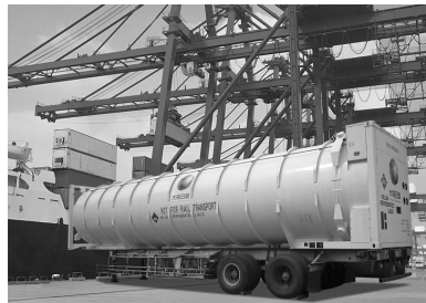
図 3-8-1-11,000 ガロン・ヘリウムコンテナ （液体ヘリウムの輸送用容器）
