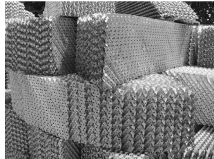
図 4-6-5-規則充填物のセグメント（英語版 WIKIPEDIA "packed bed"）
