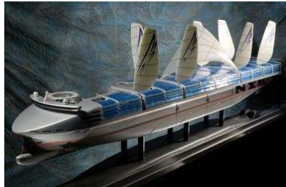
図 6-9-11-日本郵船のスーパーエコシップ構想、太陽光、風力、水素燃料電池などのハイテクを満載した次世代商船の提案
