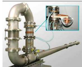
図 6-9-8-東北大学琵琶研究室の熱音 響デバイス、出典：大学 HP
